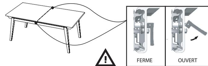
Déverrouiller les coulisses avant d'ouvrir les plateaux
